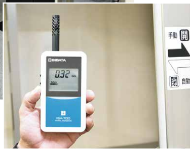
「スモブT-1」は風速0.2m/秒以上が維持されており技術基準をクリア。スライドドア式で出入りも楽々。写真は4~6人用のキューブミニタイプ。
